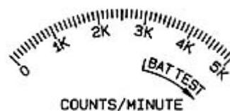
Если стрелка указывает как в образце внизу и селектор в положении  $\times 0,01$ , то показание – 3,5 кило отсчёта/мин ( $3500 \times 0,1 = 350$  отсч/мин)
